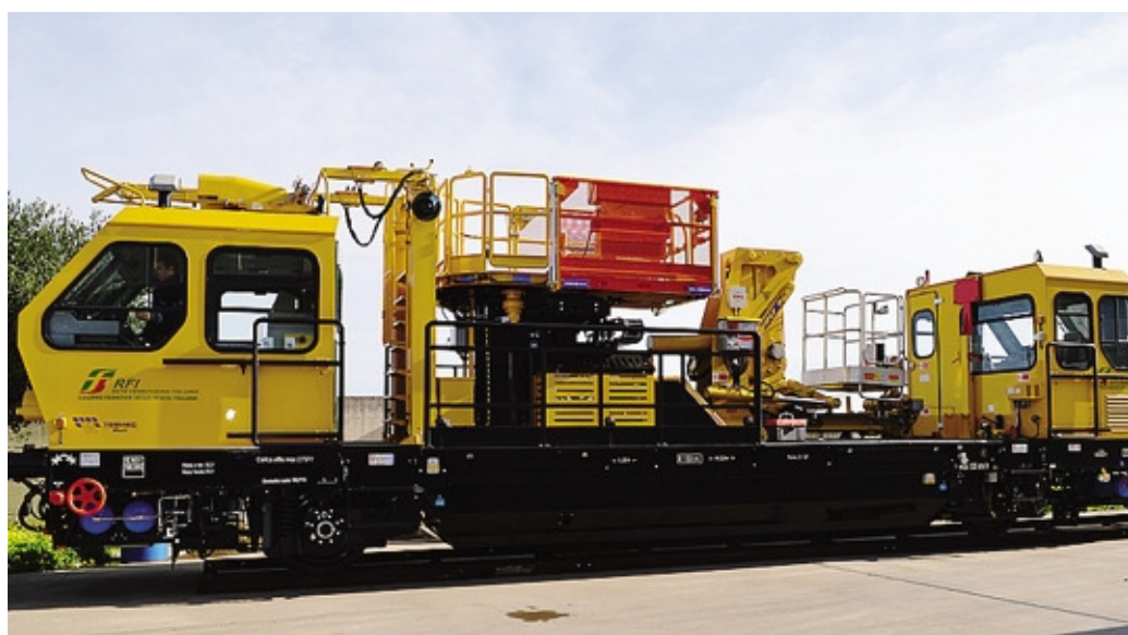
Per la manutenzione della rete ferroviaria, Tesmec in campo con la fornitura di autoscale polivalenti
